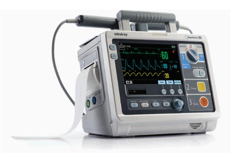
BeneHeart D3, BeneHeart D3 è un defibrillatore compatto e leggero in cui sono integrate funzioni di defibrillazione manuale, monitoraggio, stimolazione e AED. La rapidità di ricarica e la velocità di erogazione della scarica con livelli di energia personalizzati garantiscono una rianimazione efficace. La funzione intelligente per il monitoraggio dei segni vitali di ECG, SPO2 e respirazione migliora l'efficienza diagnostica e indica rapidamente l'efficacia della defibrillazione.
